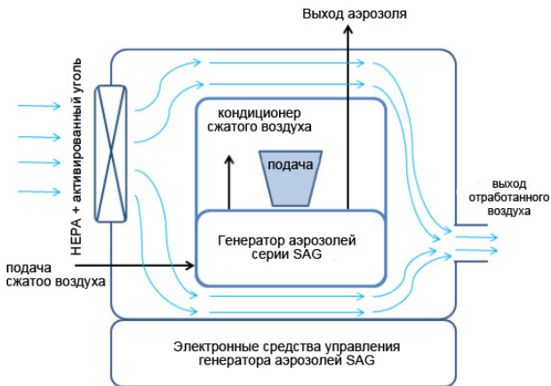
Принцип работы пылезащитной камеры DGU 413.
