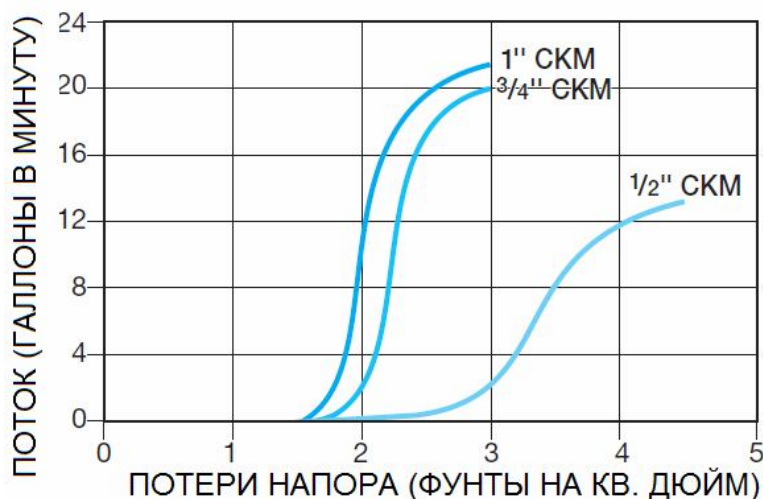
Серия СКМ – поток и потери напора рабочие кривые
