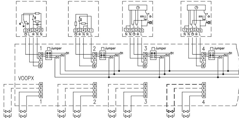
Перемычка (джампер) для определения задающего устройства и вспомогательных устройств всегда должна устанавливаться на одну и ту же временную зону. При этом нет необходимости выполнять действия в какой-либо определённой последовательности.
