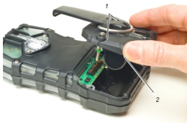
Figure 13 Remplacement de la batterie
