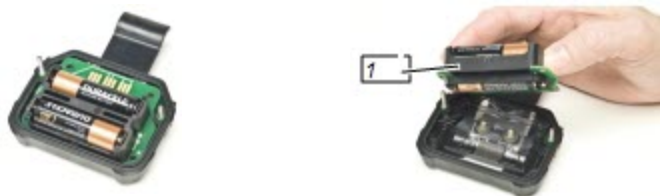
Figure 14 Remplacement de la batterie
